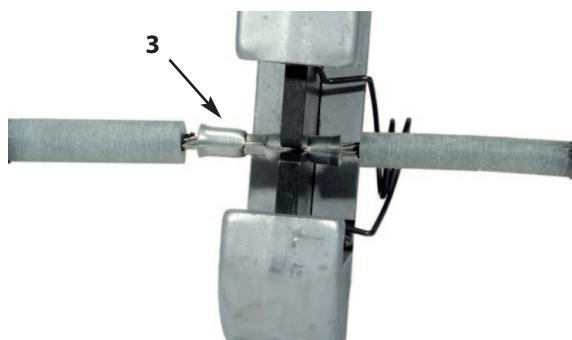
Leiter verbinden durch beidseitiges, zweimaliges Verpressen des Verbinder (3) (Sechskantpressung nach DIN 48083 Teil 4 Matrize 10mm<sup>2</sup> KZ6)
