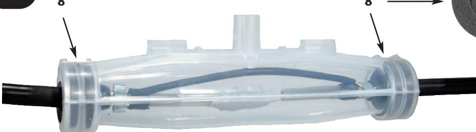
Dichtungsringe (8), mit der Öffnung nach oben, bündig mit den aufeinander-liegenden Lagen Butylband auf den Außenmantel aufbringen.
