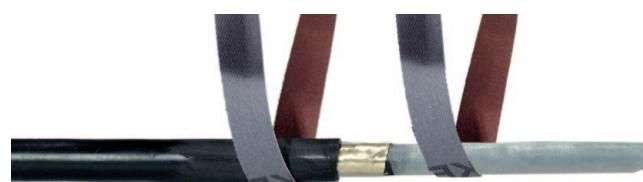
Um die Haftfestigkeit des Gießharzes auf dem Außenmantel und der Isolation zu erhöhen, sind diese mit Schmigelleinen (5) gemäß Montagebild aufzurauen und mit dem Reinigungstuch (10) zu säubern.
