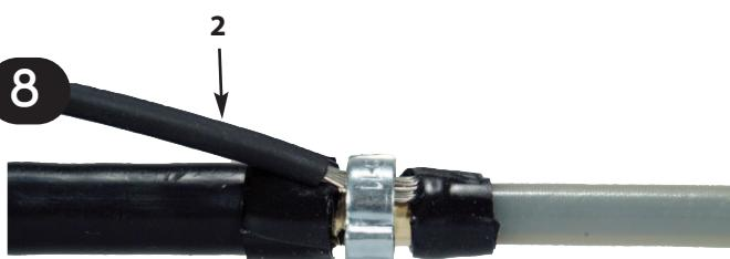
Erdleiter (2) von außen kommend zwischen Abschirmung und Schlauchschelle schieben.
