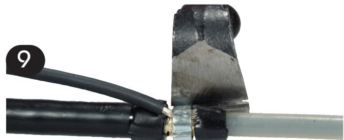
Schlauchschelle beidseitig mit Kneifzange anklammern.
