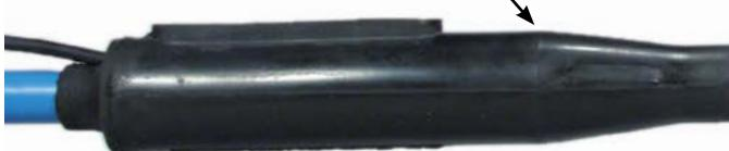
Stecker- bzw. Gegensteckerhülle (8+9) aufschieben. Dabei ist auf die gerade und konzentrische Lage des Kabels innerhalb der Gummihüllen zu achten. Der genaue Sitz der Hülle wird durch das Einschnappen auf dem Stift bzw. der Hülse gewährleistet. Kabelabdichthülle in Körper einschieben. Kontrolle : - Länge des Stiftes : 27 mm - Hülse : bündig mit innerer Abstufung der Gummihülle
