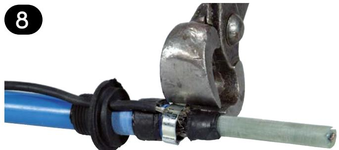
Schlauchschelle beidseitig mit Kneifzange anklammern
