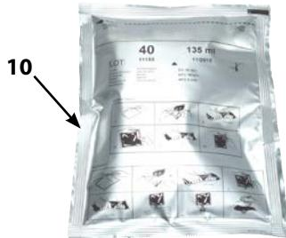
Unter Beachtung der entsprechenden Verarbeitungsanweisung Gießharz (10) langsam blasenfrei eingleßen. Im Ruhezustand aushärten lassen. (Die Dauer hängt von der Umgebungstemperatur ab)
